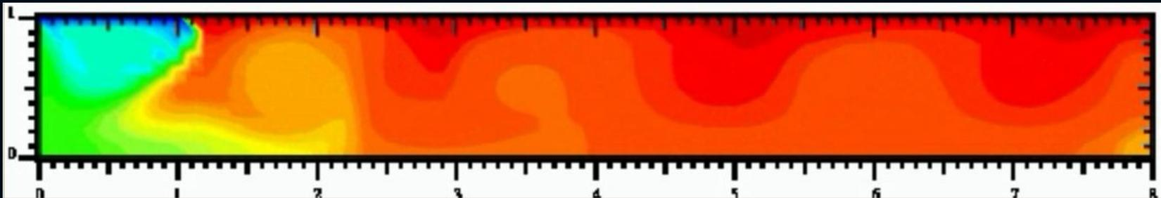
電極挿入の有無による, ガラス溶融炉内部の温度分布の違い
