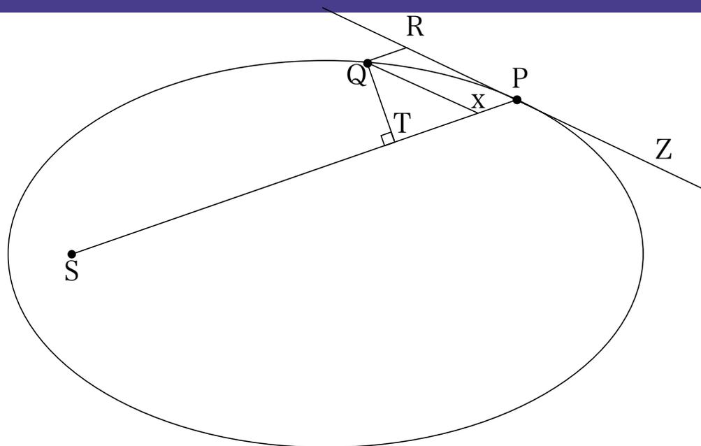
$Q$  から  $SP$  に垂線  $QT$  を下すと、 $\Delta t$  が小さいときは扇型  $SPQ$  の面積  $\approx \triangle SPQ$  の面積なので、
