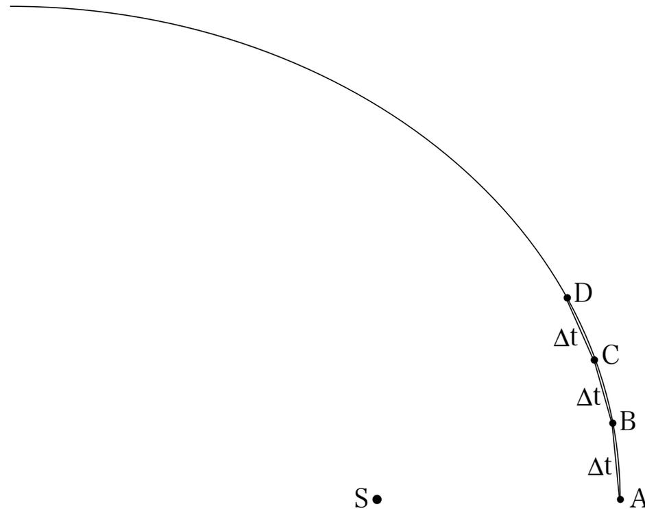
力の中心を  $S$  とする求心力による運動を、ある点  $A$  から微小時間  $\Delta t$  だけ慣性運動して  $B$  に来た後に、 $S$  方向の衝撃力を受けて運動の向きが変わり、また  $\Delta t$  後に  $C$  で  $S$  方向の衝撃力を受ける、という折れ線で近似する。
