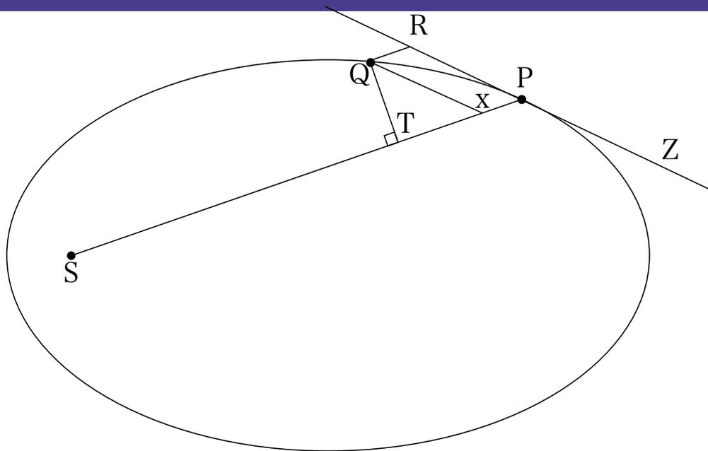
$Q$  から  $SP$  に垂線  $QT$  を下すと、 $\Delta t$  が小さいときは扇型  $SPQ$  の面積  $\approx \Delta SPQ$  の面積なので、面積速度を  $\kappa$  として
