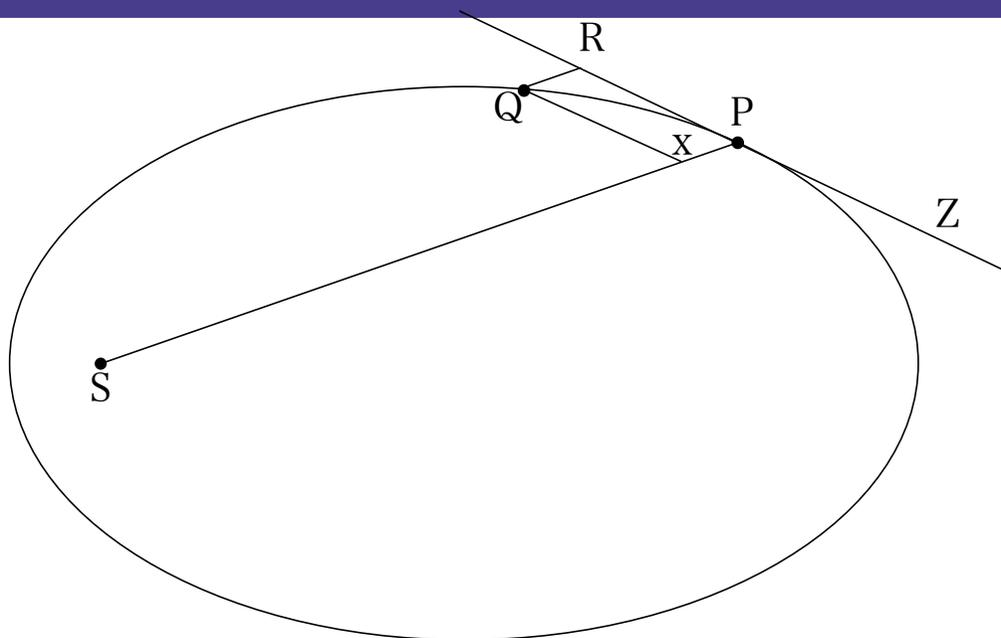
微小時間  $\Delta t$  の間に物体が  $S$  を中心とする求心力を受けながら  $P$  から  $Q$  へ動いたとする。
